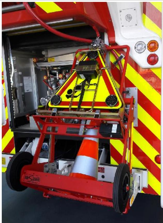
Il permet le stockage, le transport et la mise en œuvre de trifiashes et de cônes de Lubeck en optimisant au mieux la sécurité de l'ensemble des acteurs de l'intervention.
